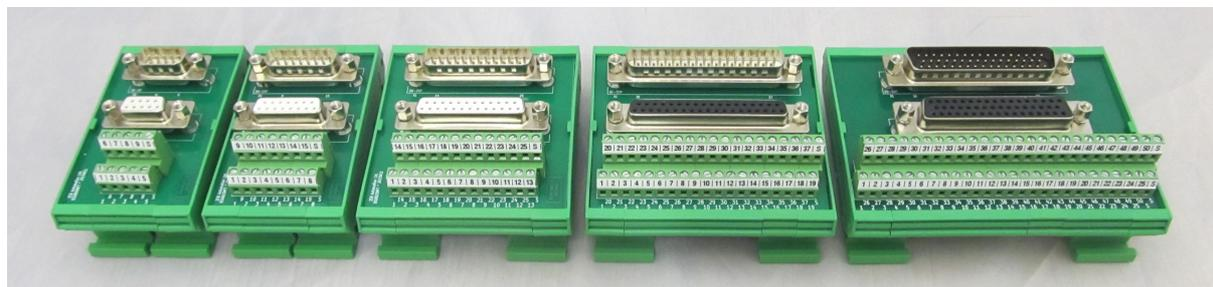
Die Module dienen der Umsetzung von D'Sub-Anschlüssen auf Schraubklemmen. Zur vereinfachten Lagerhaltung sind sowohl D'Sub-Stecker als auch D'Sub-Buchsen der jeweiligen Polzahl bestückt, die direkt parallel verbunden sind. Über die Klemmen können die erforderlichen Leitungen leicht mit einer bestehenden Festverdrahtung verbunden werden. Zur Montage im Schalt-schrank kann das Modul auf die gängigen Tragschienen TS15, TS35 und G32 aufgerastet werden.
